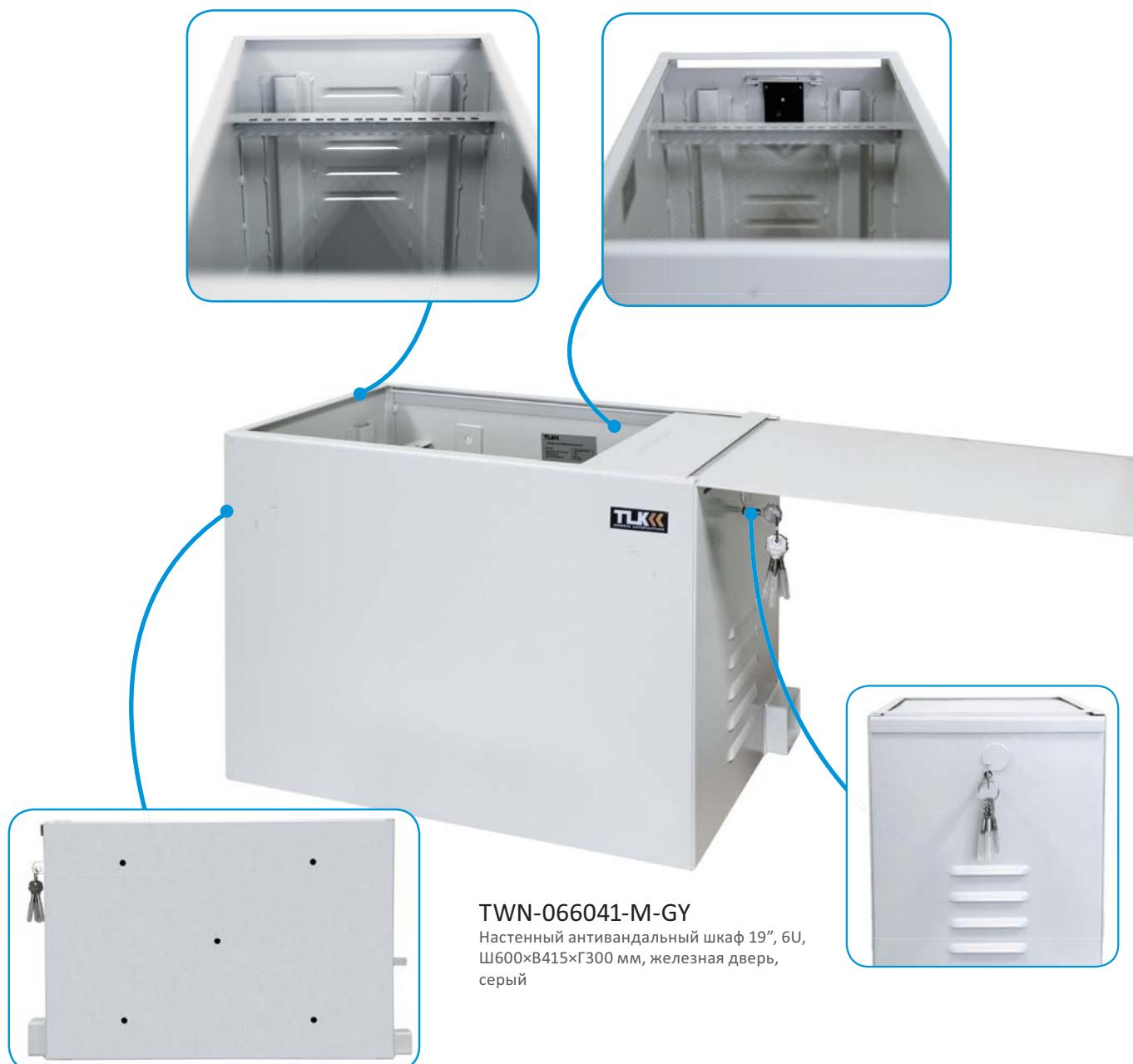
Шкафы выполнены в 19" стандарте. Оборудование в шкаф устанавливается вертикально, параллельно боковым стенкам. Конструкция неразборная цельносварная. Все элементы шкафа изготовлены из 2 мм стали, а направляющие — из 1,5 мм стали. Сдвижная дверь-крышка снабжена замком повышенной секретности, в комплект входят 4 ключа. Для уста-
