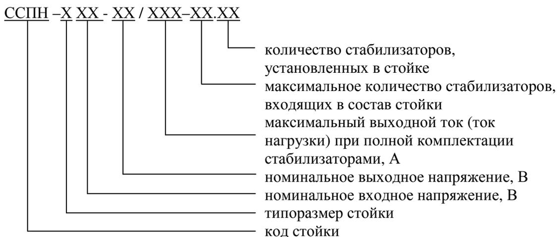
ССПН рассчитаны на работу с естественным охлаждением и обеспечивают:
